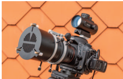
Samyang 2.0/135 mm mit der Bahtinov-Maske und Mikrofokussierung
